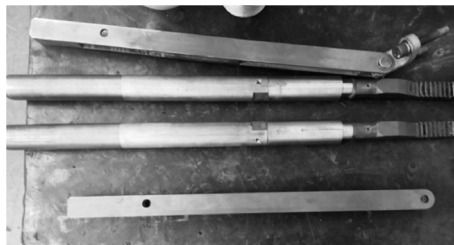
图12 10 000次机械操作后优化方案的拉杆及静弧触头状态
